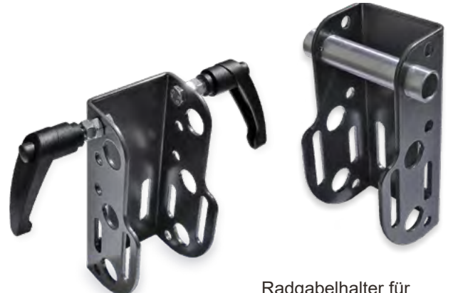
Radgabelhalter für Steckachsen (Gabelinnenmaß und Steckachsendurchmesser erforderlich)
