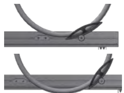
Die Schalen können stufenlos in Abstand und Winkel eingestellt werden. So wird das Rad beliebig in der richtigen Höhe eingestellt (die komplette Türhöhe ist nutzbar)
