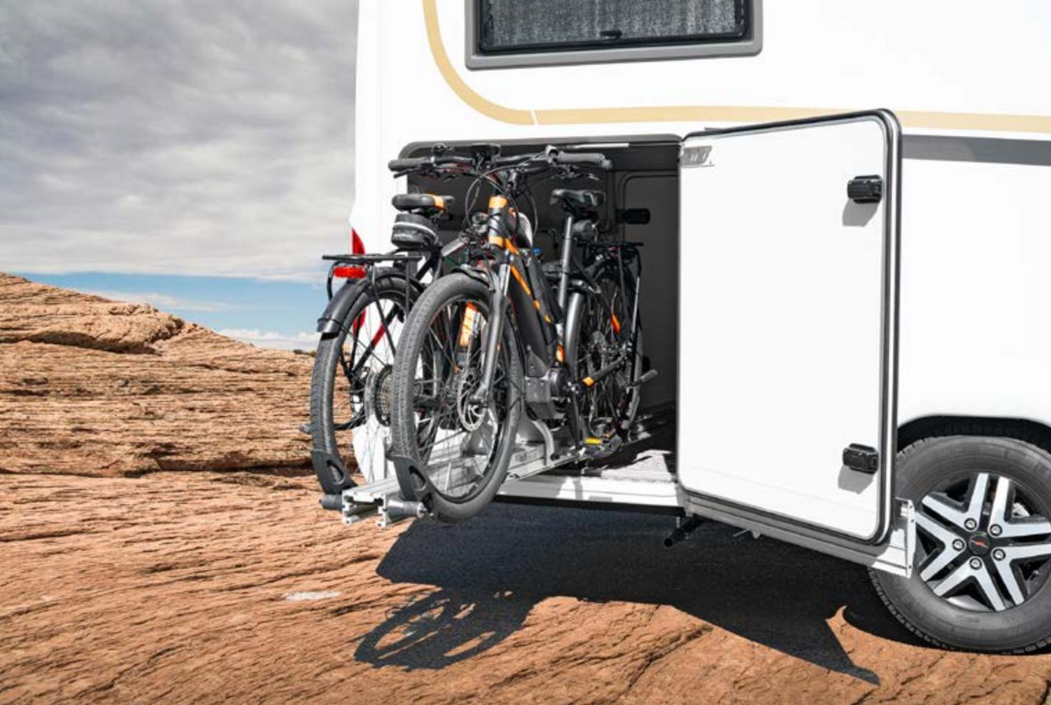
Um die Fahrräder in die Heckgarage zu laden, wird der Träger mit einer Hand entriegelt und bis zum Anschlag herausgezogen. Die Fahrräder werden in die dafür vorgesehenen Schalen gestellt, in denen sie schon einen hervorragenden Stand haben. Der Träger wird in der Heckgarage auf Querverschiebeprofilen montiert. Durch die zusätzliche seitliche Verschiebemöglichkeit in der Heckgarage können die Fahrräder nach dem Beladen platzsparend zur Seite geschoben werden.
