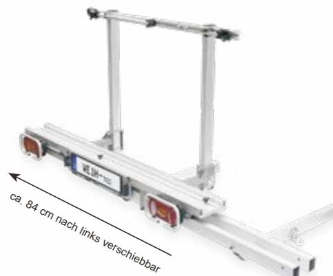
Ohne die Ladung abzunehmen kann dieser Träger seitlich nach links verschoben werden. Dadurch wird das Öffnen der rechten Hecktüre bequem und ohne großen Aufwand ermöglicht. Da nur die fahrzeugspezifischen Stahl-Aufnahmen fest am Fahrzeug-Chassis montiert werden, kann der Träger selbst (ca. 40 kg) ganz problemlos und schnell abgenommen bzw. angebracht werden.
