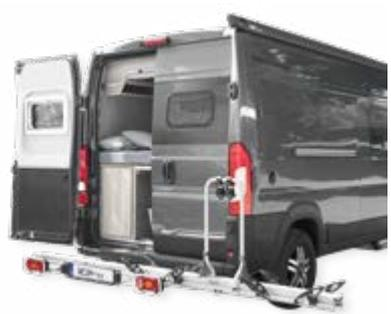
Ohne die Ladung abzunehmen kann der Träger seitlich nach links oder nach rechts verschoben werden, um dahinter liegende Türen oder Klappen zu öffnen. Da nur die fahrzeugspezifischen Stahl-Aufnahmen fest am Fahrzeug-Chassis montiert werden, kann der Träger selbst (ca. 29 kg) ganz problemlos und schnell abgenommen bzw. angebracht werden. Sehr gut für den Transport von schweren E-Bikes geeignet. Die Fahrräder haben einen Abstand von 25cm und werden mit Befestigungsarmen am Träger gesichert.
