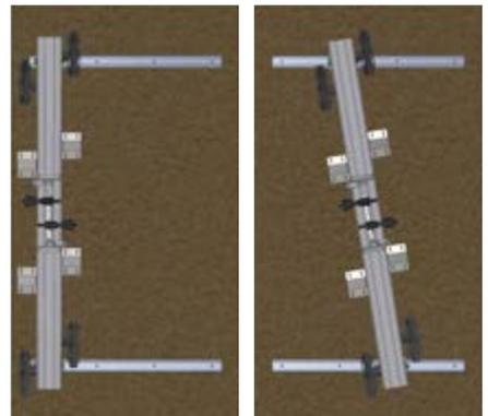
Auf den Querprofilen kann der Träger in der Garage oder auch im ausgezogenen Zustand sehr flexibel nach links oder rechts verschoben werden, auch mit Fahrrädern beladen. In der optimalen Position wird der Träger fixiert.
